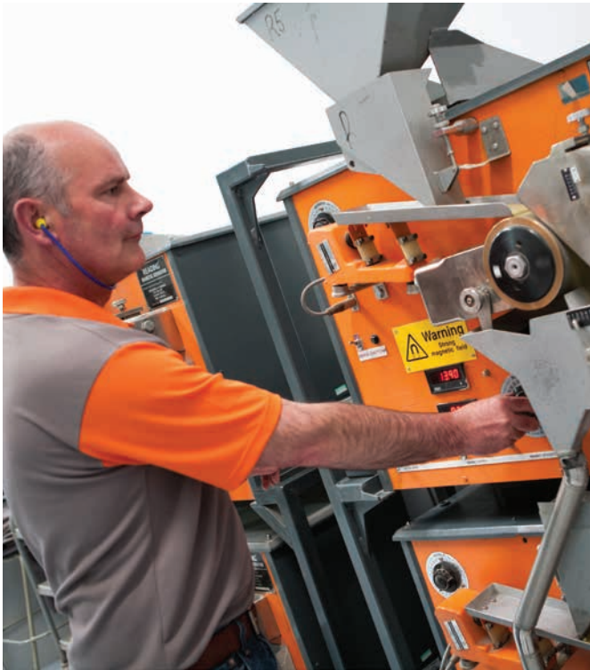
在元素六的Micron+生产中心，人造金刚石来料经过磁选，磨成所需的粒度与形状。这些微粉颗粒经过清洁、清洗后再沉降。
